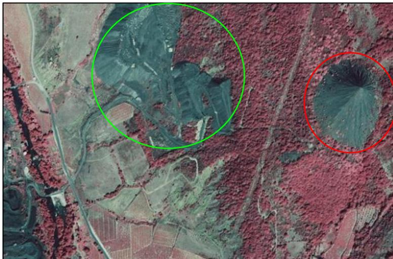
Alors que le carreau de La Borie se trouvait en rive droite de l'Orb, les stériles étaient déposés en rive gauche. Tout d'abord sous la forme d'un terrier plat (localement appelé "terrier", **cerclé vert**) au pied de la pente des Moucheyres ; puis, durant les années 1950-1960, sous la forme d'un terril conique (**cerclé rouge**) situé plus haut et alimenté par un télébenne aérien.
