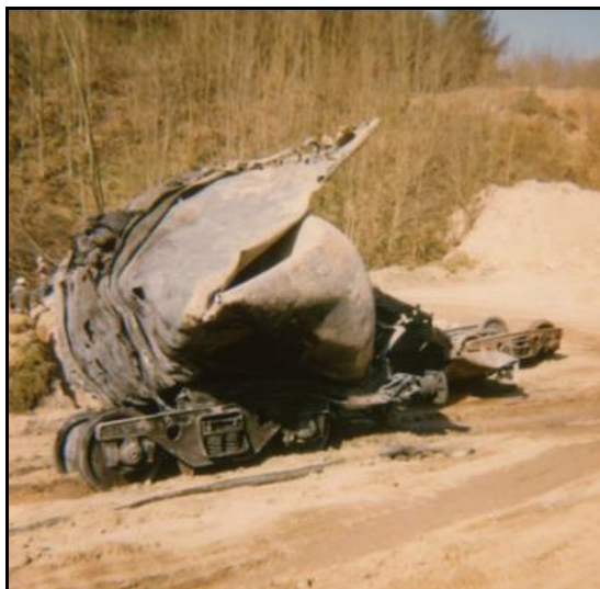
Les restes calcinés d'une citerne
