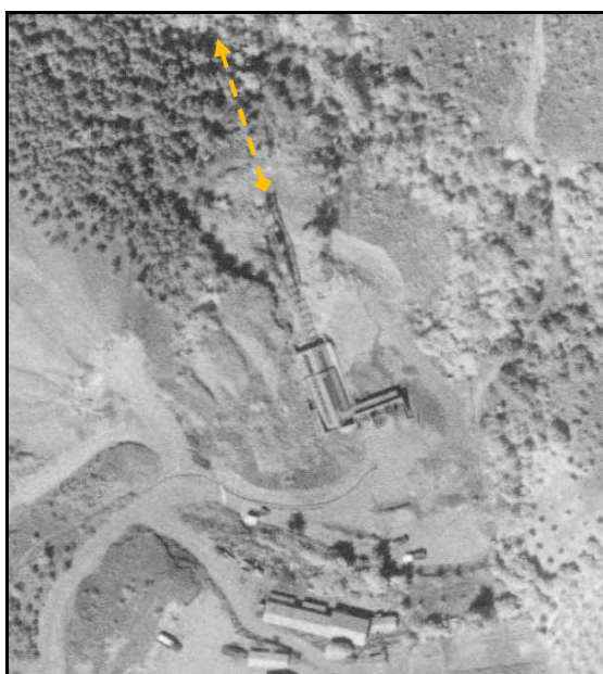
Vues aériennes ancienne et actuelle du départ du transbordeur de Gante Sur la photo de droite, on voit bien la longue estacade de support des câbles située à la sortie de la gare
