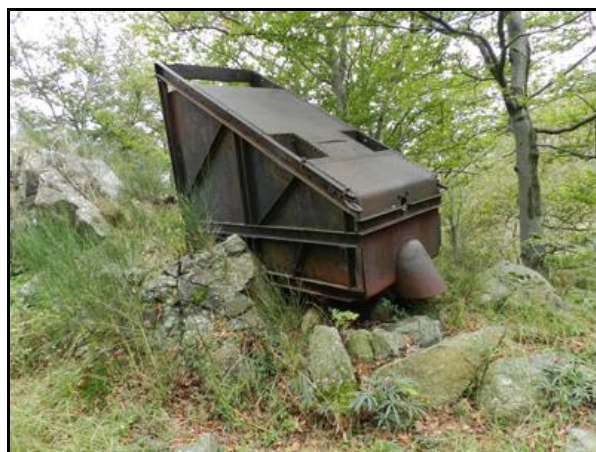
Principe de fonctionnement du plan incliné et, cul par-dessus tête, au bord du chemin, l'une des deux bennes avec son plateau de chargement face au sol Noter la gueule par laquelle on la remplissait d'eau
