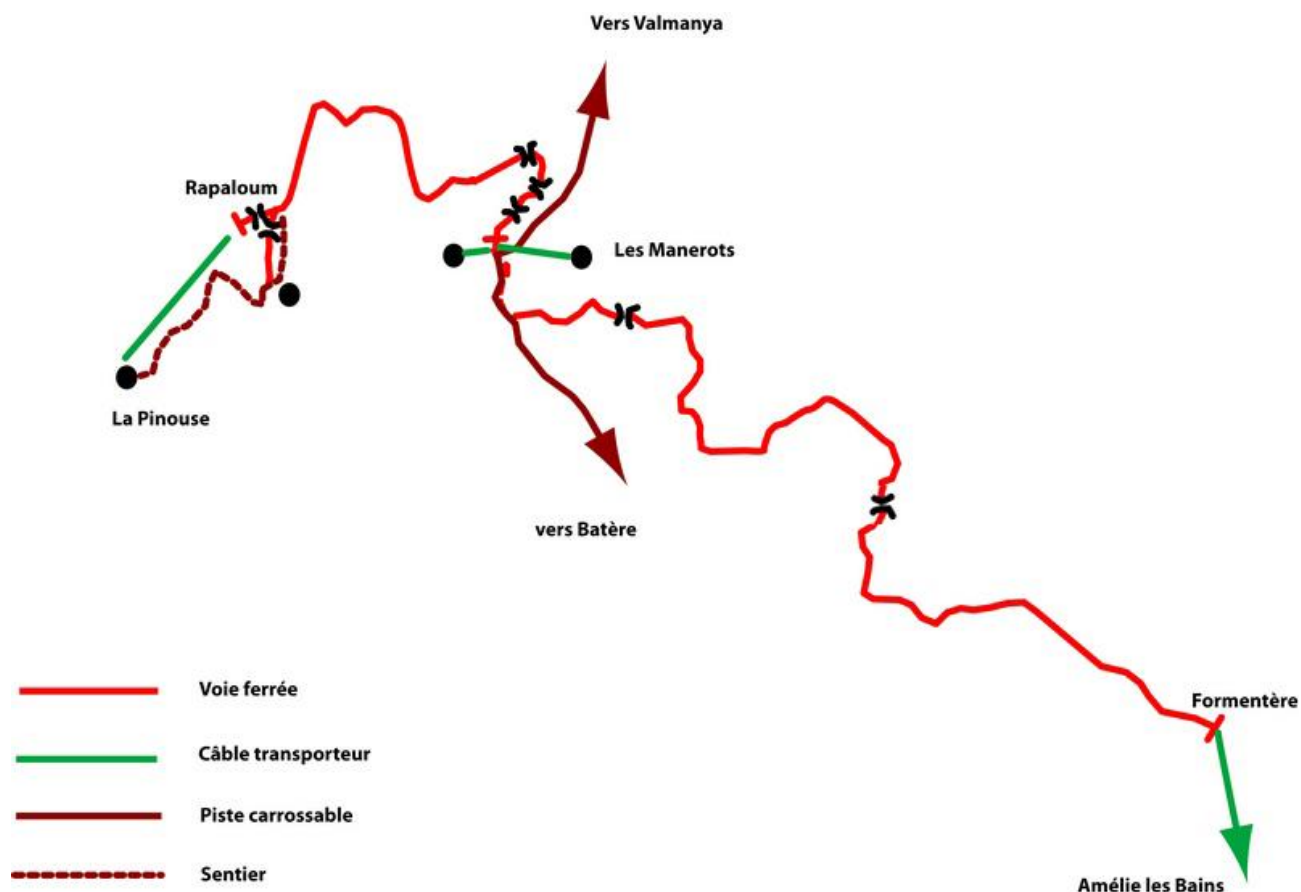
Schéma des 12 km de la voie ferrée minière et de ses amusants petits tunnels
