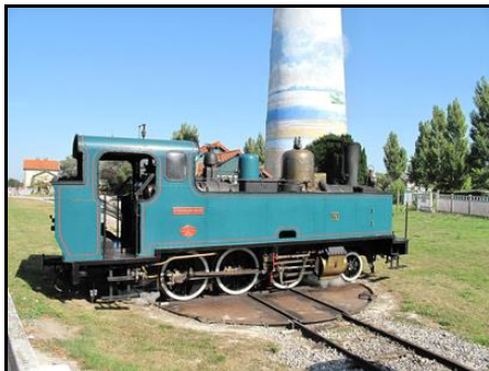
Retournement de locomotive à vapeur sur plaque et pont tournants
