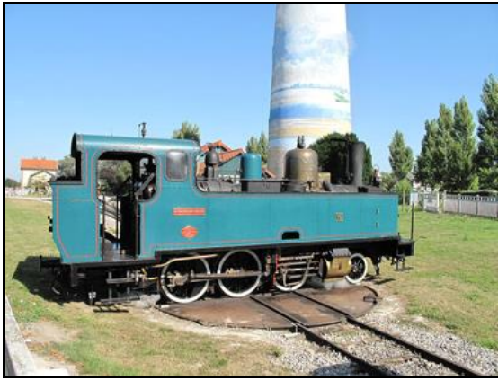
Retournement de locomotives à vapeur sur plaque et pont tournants
