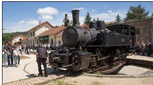
Retournement de locomotive à vapeur sur plaque et pont tournants
