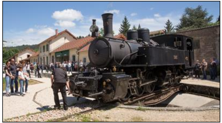
Retournement de locomotives à vapeur sur plaque et pont tournants
